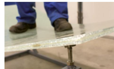
*Ensayo de fatiga, proceso de control del vidrio*
